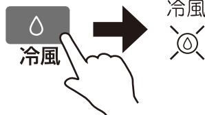
ランプが点灯しているときは、給水ポンプで水タンクの水を吸い上げ、冷風運転をしています。冷風ボタンを押すごとに冷風運転と送風運転が切換わります。
