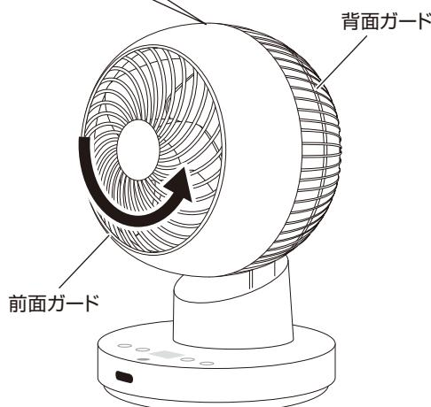
※前面ガードを取り付けるときは、前面ガード上部の「合わせマーク」を背面ガードの「目印マーク」に合わせてはめ込み、「ロック位置マーク」と「目印マーク」がまっすぐ揃うようにしっかりと回してください。
